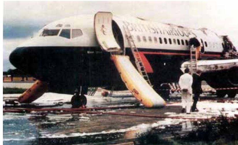
FIGURE 2: Boeing 737-236 : accident au décollage de l'aéroport de Manchester en raison d'une panne de moteur. 78 passagers sur 131 passagers dont 2 membres de l'équipe cabine ont perdu la vie. La plupart des décès étaient dus à l'inhalation de fumée. L'accident a contribué à apporter des changements pour rendre l'évacuation des avions plus efficace et a été décrit comme «un moment déterminant dans l'histoire de l'aviation civile». Selon les recommandations de la direction des enquêtes sur les accidents aériens, l'industrie aéronautique a modifié la disposition des sièges près des sorties de secours, des housses de sièges résistantes au feu, des lampadaires résistants au feu, des extincteurs et des règles d'évacuation plus claires.
